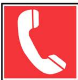
TELEFONE PARA LUTA CONTRA INCÊNDIO
